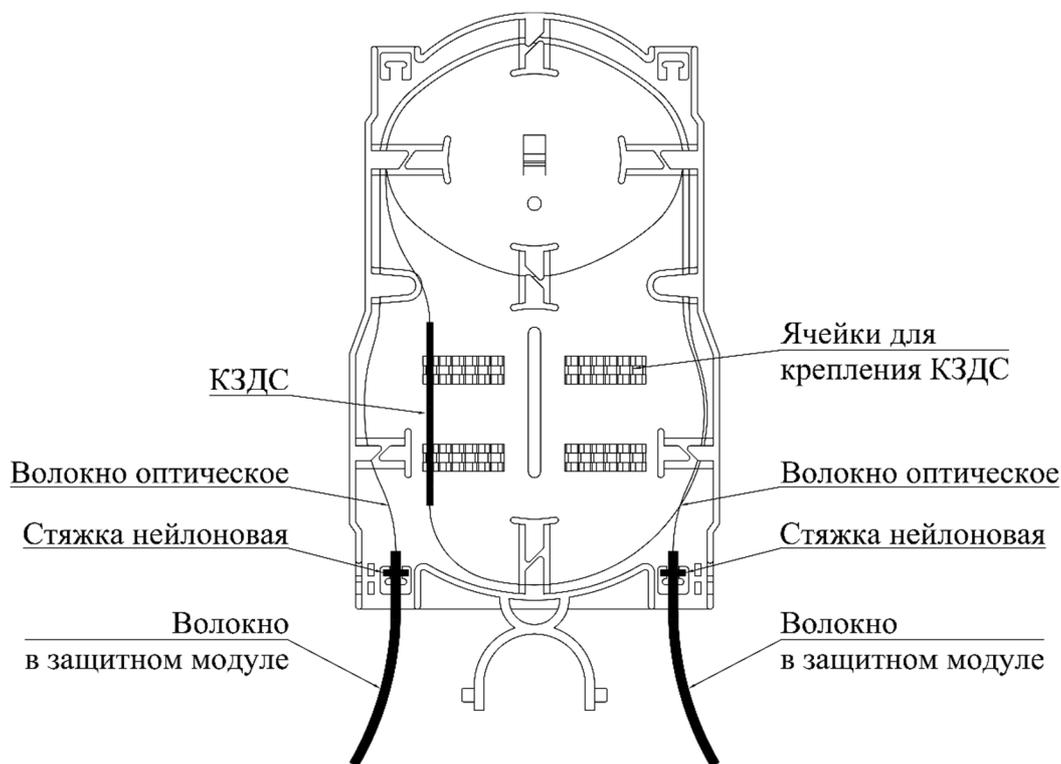
4.3. По окончании сращивания закройте сплайс-кассету защитной крышкой.
