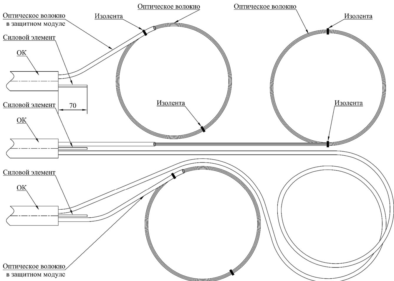
2.5. Закрепите OK и силовой элемент OK. При необходимости соедините экран или броню OK с экраном муфты для обеспечения непрерывности соединения.
