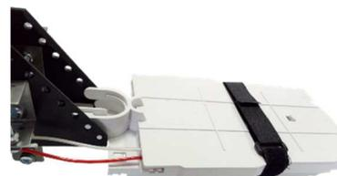
Для стандартизации рабочего процесса и паспортизации сварки был создан адаптер-переходник для установки в муфту стандартной кассеты КТ-3645 производства "Связьстройдеталь".
