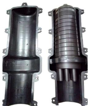
Тупиковая конструкция, Оголовник имеет 5 вводов: один овальный ввод диаметром 22 мм для ввода транзитной петли или двух ОК, 4 круглых ввода ОК диаметром до 17,5 мм.
