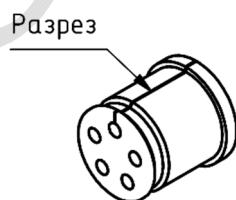
6.3. Проденьте нужное количество оптических шнуров через гайку и цангу, затем просуньте в прорезанные отверстия в уплотнителе и далее внутрь муфты-кросс.
