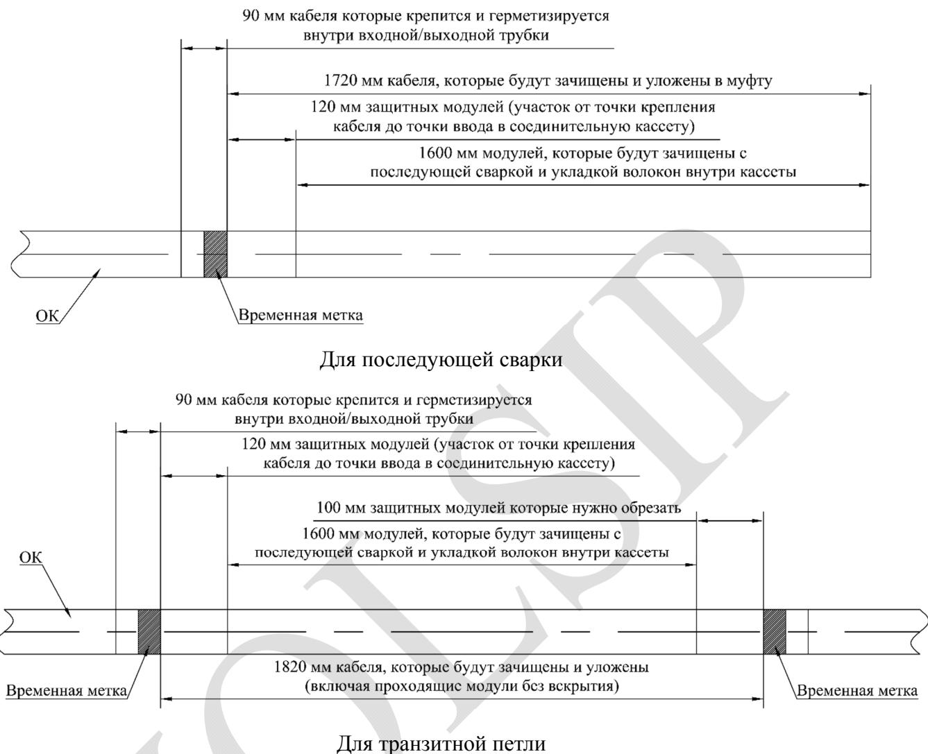
2.2. Намотайте два слоя изоляционной ленты на оболочку кабеля. Затем удалите гидрофоб, сняв модульную трубку, с помощью тканевой тряпки и специальной жидкости (либо бензина) для того чтобы разделить волокна. Каждое отделенное и протертное от гидрофоба волокно смотайте в кольцо диаметром около 100 мм и закрепите изолентой.
